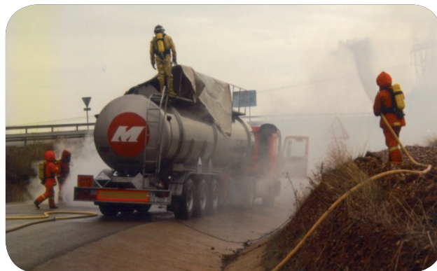
Dispersión de vapores producidos en una fuga de un líquido corrosivo.
