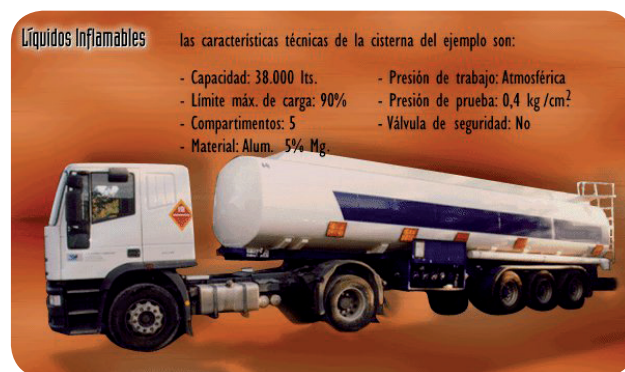
Cisterna compartimentada transportando distintos hidrocarburos. Cada compartimento debe llevar su panel naranja y las etiquetas de peligro correspondientes al producto que contiene.
