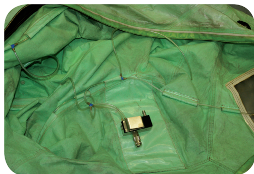
Circuito de aireación de traje Nivel III.
