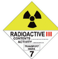
Encontraremos esta etiqueta en los bultos cuya radiación exterior sea inferior a 2.000 \mu\text{Sv/h} .
