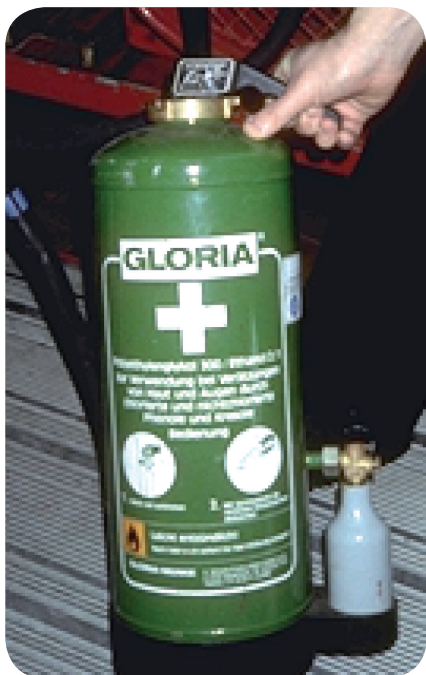
Propilenglicol en recipiente de extintor listo para ser usado en una descontaminación urgente.
